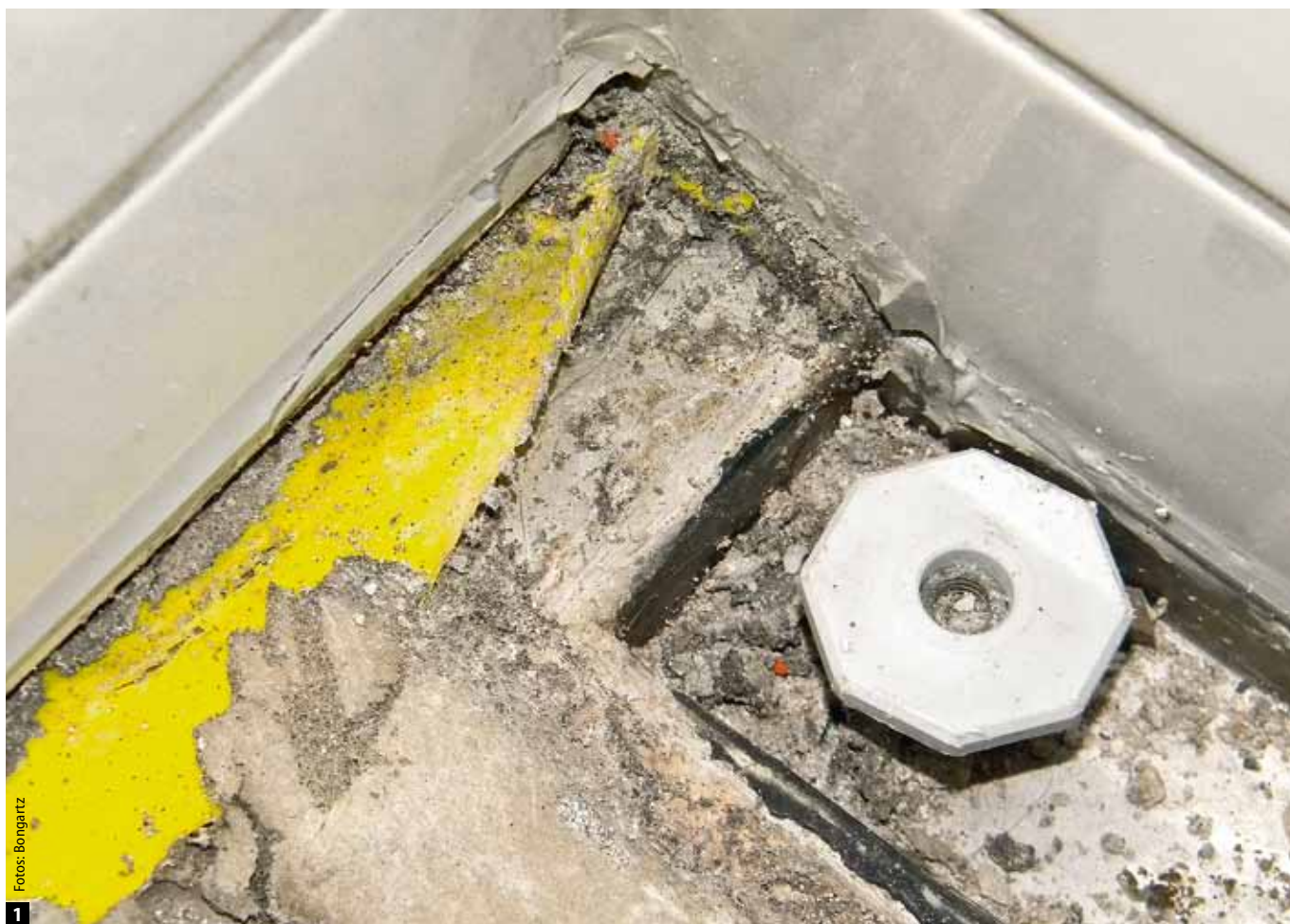
1 Fallbeispiel 1: Unsachgemäß eingedichtete Ablaufrinne
